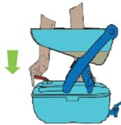
Realice el primer retrolavado después de un día de uso: Verifique que ambos depósitos contengan por lo menos un poco de agua. Luego presione la palanca roja de retrolavado hasta abajo, suavemente, sosténgala por 15 segundos y suéltela.
