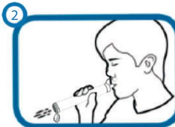
Después de haber bebido el agua, sople aire a través de su boquilla para expulsar el agua sucia, manteniéndolo de esta forma internamente limpio y previniendo que se tape.
